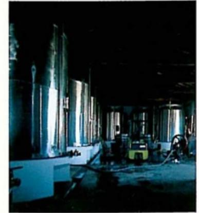
ステンレス製発酵槽
