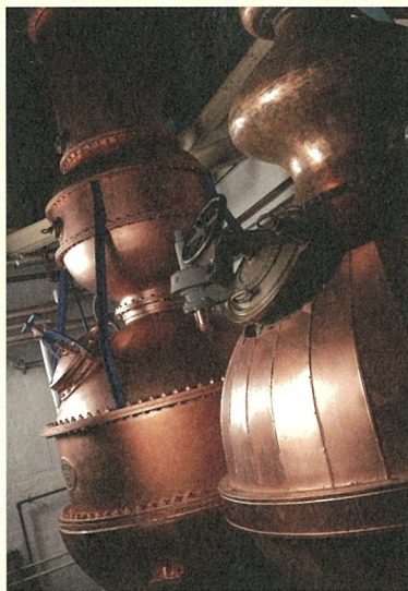
右：ベネット スチル 左：カーターヘッド スチル
